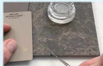
補修充填部にセラミックカードの色を筆で彩色
