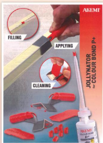
カウンターのトメ加工に使用されているAKEMIカラーボンドのお助けTOOLの紹介です。出隅に充填したボンドを綺麗に成形することができる成型ツールです。洗面台・階段・窓枠・棚・浴槽パネルなどの90°と135°に対応が可能で、充填作業時に起こるエアポケットも軽減できるためロス率も少なく経済的です。
