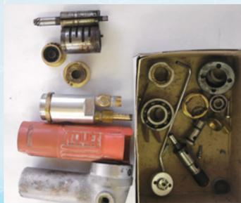
故障した商品を分解検品すると、ベアリングに錆が発生しているものが多くあります。ベアリングが錆びることで、ギアに負担がかかり故障を発生させます。
