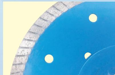
通称ウェーブカッターとも呼ばれ刃先に細かなスリットを入れることで、切粉が逃げやすく放熱がしやすくなり冷却効果をあげます。チッピングを無くするため薄刃で切断面の仕上がりを重視したタイプです。
