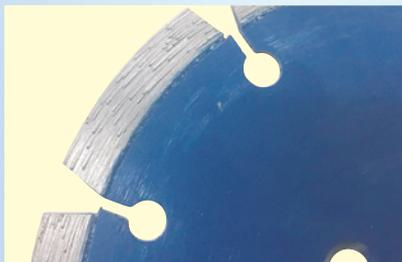
刃の形状はセグメントタイプと呼ばれ、切断時に発生する摩擦熱を放出し冷却効果を大きくするために、大きなスリット(切れ込み)があるのが特徴です。御影石の他、コンクリート、レンガなどにも使用することが出来ます。
