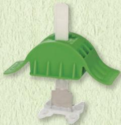
「MLTシステム」は、床や壁への石材・大判タイル貼り付け時の段差を平滑にする最新の不陸調整施工システムです。従来、床や壁の石貼り・タイル貼りの際の不陸調整は水平器をあてハンマーでトントン叩いて行います。これは職人さんの腕にかかっているといっても過言ではありません。しかし建築施工の職人不足が問題となってきています。その点「MLTシステム」は誰でも簡単に施工が出来るので、熟練の職人ではなくても安定した施工品質を保つことができます。結果、工期短縮となりコスト削減が実現できます。
