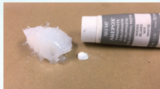
主剤と専用着色ペーストを混ぜ補修する石の色に合わせる。
