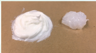
主剤2:硬化剤1の割合でよく混ぜ合わせる。
