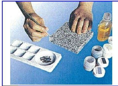
⑤ 硬化後、余分な部分を研磨します パウダーを密着液で溶かし、着色または柄を描きます
