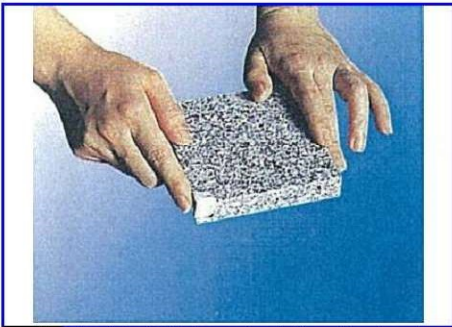
④ キズの部分に、よく練ったパテを少量つつすりつけるようにして埋めて盛っていきます 自然乾燥で15～20分、急ぐ時はドライヤーを使用します
