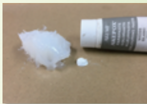
② 主剤と専用着色ペーストを混ぜ補修する石の色に合わせる。
