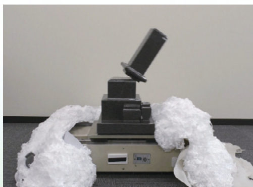
起震機による倒壊実験
