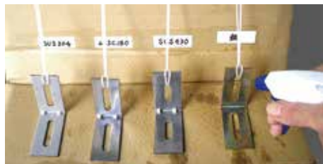
塩水噴霧試験での発錆状況の比較例 (当社にて実施)
