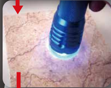
LEDライトの光を二分程 照射して硬化させます
